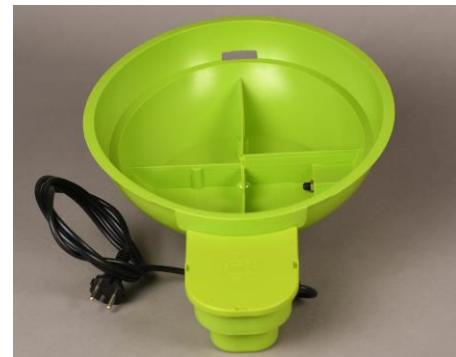
Inizialmente riempire solo il primo settore, attendere almeno 1 ora e verificare la lettura dell'umidità sul display, se fosse bassa, procedere al riempimento del 2° settore, ripetere nuovamente l'operazione fino a raggiungimento della corretta umidità del 47-50% UR durante la fase di incubazione; mentre gli ultimi 2 giorni durante la schiusa aumentare al 60-65% UR.
